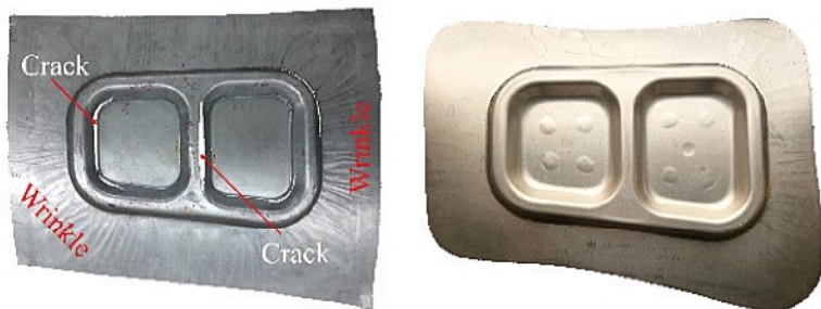
图4 5A06铝合金复杂薄壁口框零件 (a) 落压成形，(b) 冲击液压成形。
