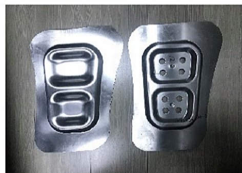
图5 冲击液压成形的2B06飞机板件，2道次，无中间热处理，无人工辅助，冲孔成形同模具一次完成。
