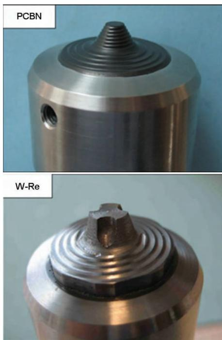
图7 聚晶立方氮化硼(PCBN)和W-Re合金搅拌头形貌<sup>[80]</sup>
