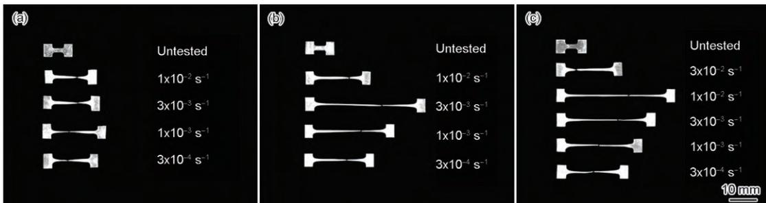
图 9 不同转速下 FSP 样品超塑性测试的拉伸样品形貌
